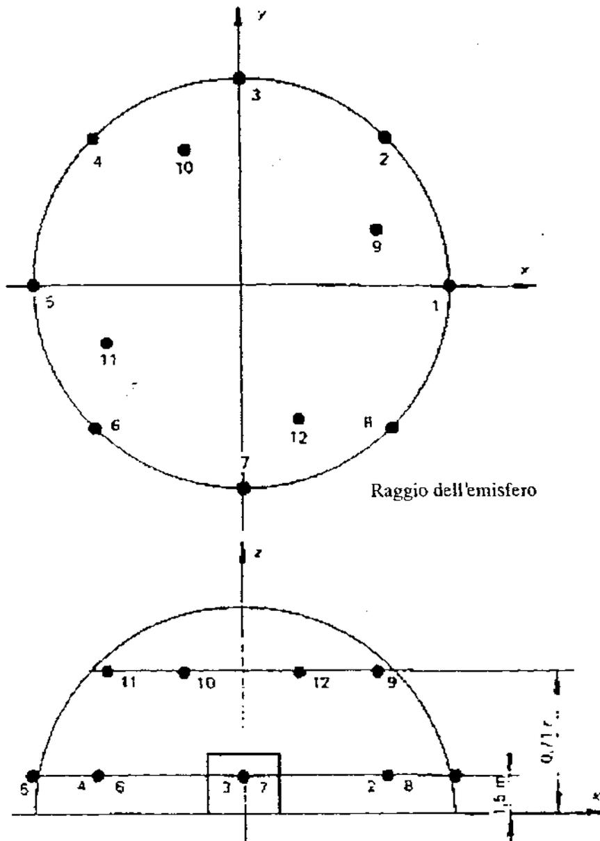
**PARTE B****METODI DI PROVA DELL'EMISSIONE ACUSTICA PER CIASCUN TIPO DI MACCHINE ED ATTREZZATURE****0 MACCHINE PROVATE A VUOTO****Norma di base sull'emissione acustica**
